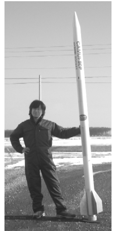
打上げ機体の外観 外殻は繊維強化プラスチック
