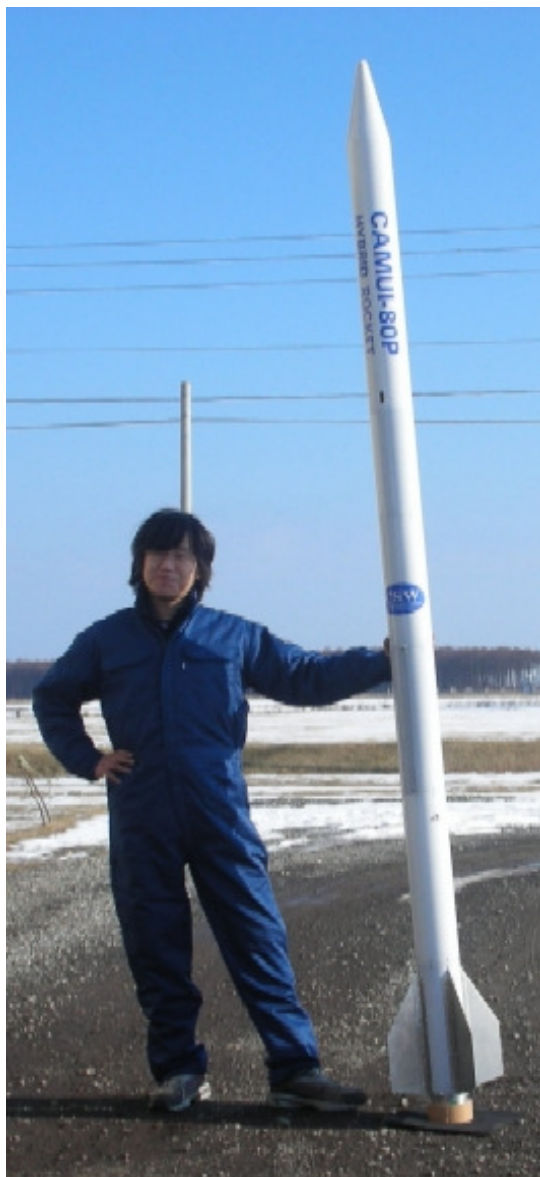
図1 打上げ機体の外観 外殻は繊維強化プラスチック
